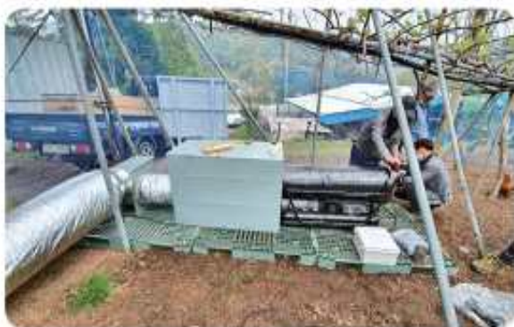
〈열풍 송풍시스템 설치 모습〉
